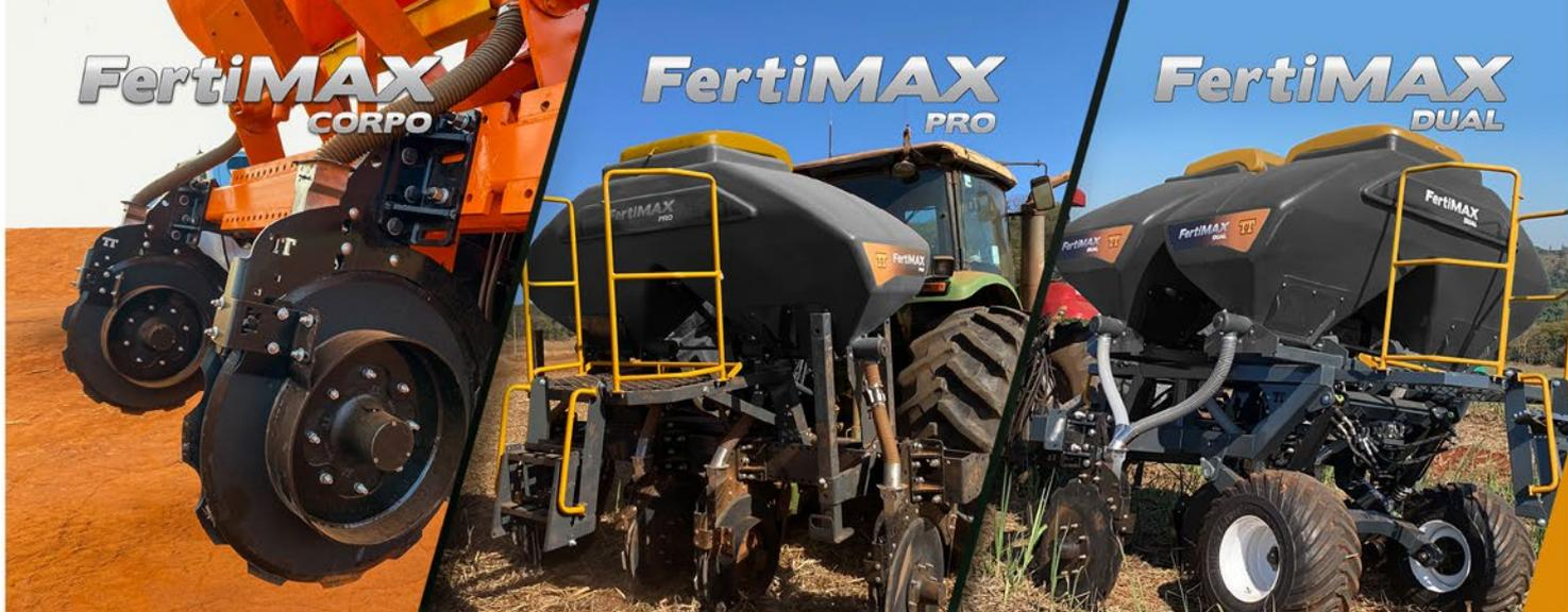
A TT possui uma linha de incorporadores de adubo chamada FertiMAX, reconhecida pela robustez, inovação e capacidade de atuar sobre altos volumes de palha. Inicia pelo Corpo FertiMax, aplica o adubo em uma profundidade de 7 a 12 centímetros, para adubação de soqueiras, que pode ser adaptado a um chassi de qualquer marca.
